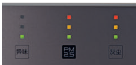
Trojité monitor čistoty vzduchu udává stav zápachu, PM2,5 a prachu.
